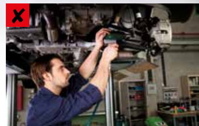
Non utilizzare una pistola di serraggio: si rischia di danneggiare e/o ridurre le prestazioni dei componenti.
