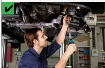
Utilizzare una chiave dinamometrica per il fissaggio del componente in modo corretto.
